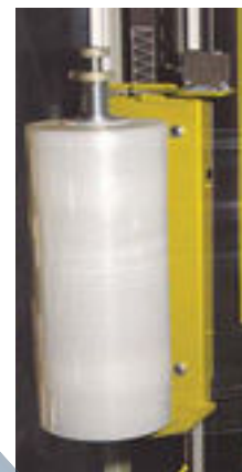
Carrello porta bobina con freno meccanico
