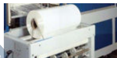
Sistema di caricamento del film dal basso.
