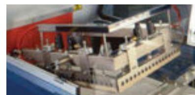
Barra saldante con lama in acciaio inox teflonata, in un unico pezzo, con angoli arrotondati per eliminare il rischio di rottura del film.
