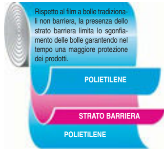
BOLLA STANDARD BARRIERA Diametro: 9,5 mm - Spessore: 4,2 mm
